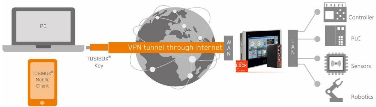
TOSIBOX 是一間為 OT 工業網路提供 VPN 加密通道的芬蘭解決方案商公司。TOSIBOX VPN 遠端連線設備，主要解決客戶端無 IT 人員編制基礎上，可自行利用此設備升級「安全物聯網連線、遠端維護及網路管理」等能力。TOSIBOX 最大優勢為『簡單化』，就算沒有任何 IT 背景也可輕鬆設定 VPN、點對點(End-to-End)加密、無需雲端設定、無需固定 IP 等特點，只需插上網路線、並將金鑰下載至電腦，就可遠端連線。
