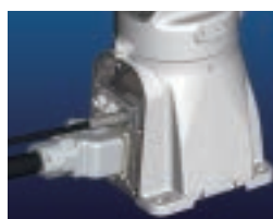
給電ケーブルの側面出しと底面出し(オプション)
